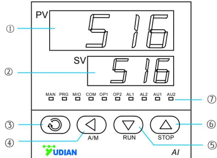
仪表上电后进入基本显示状态，此时仪表上、下显示窗分别显示测量值 (PV) 和给定值 (SV)，下显示窗还可交替显示以下字符表示状态：① “orAL”，表示输入的测量信号超出量程；② “HIAL”、“LoAL”、“HdAL”或“LdAL”时，分别表示发生了上限报警、下限报警、偏差上限报警、偏差下限报警；③ “StoP” 表示处于停止状态；“HoLd” 和 “rdy” 分别表示暂停状态和准备状态（仅AI-516P程序型仪表使用）。
