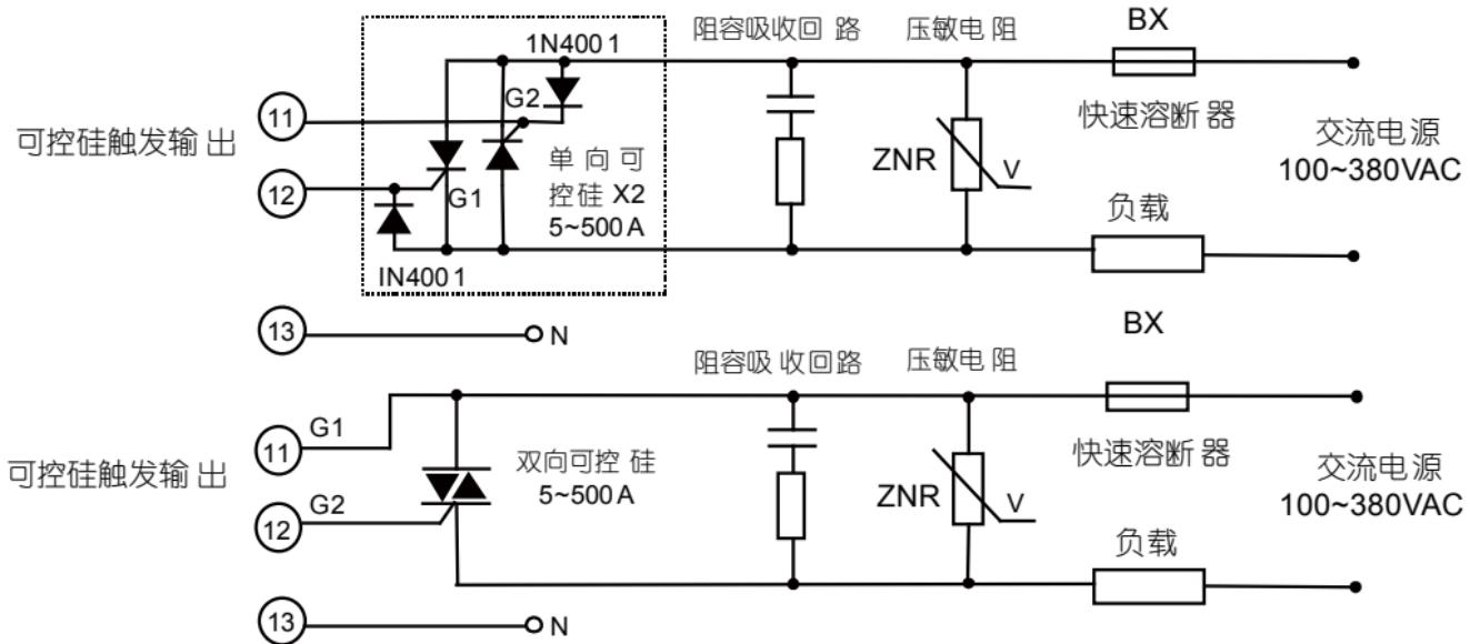
注1：根据负载的电压及电流大小选择压敏电阻以保护可控硅，负载为感性或采用移相触发时必须加阻容吸收。
